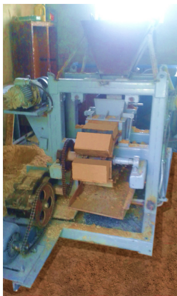
Рисунок 3 – Образец установки непрерывного формования глиняных кирпичей
