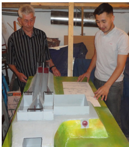
Рисунок 6 – Макет напорного бассейна совмещенного с отстойником
