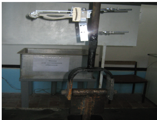
Рисунок 2 – Общий вид испытаний и характер потери несущей способности подвесок свода стекловаренной печи
