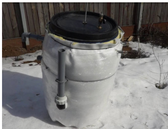
Рисунок 2 – Бочка для получения биогаза
