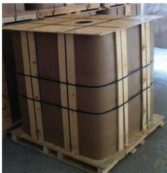
Рисунок 9 – Кloverтейнер, усиленный пластиковыми стяжками
