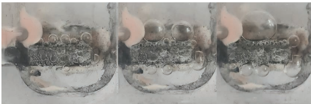
Рисунок 7 – Генерация газа и электроэрозия на поверхности электрода (анод)
