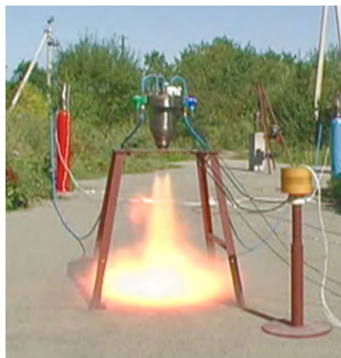
Рисунок 6 – Выброс газообразных продуктов детонации в атмо-сферу при взрыве в генераторе заряда из стехиометрической смеси водорода и кислорода
