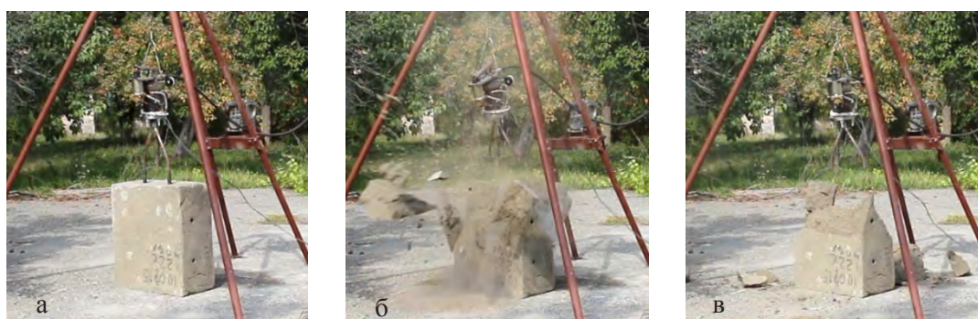
Рисунок 11 – Состояние разрушаемого блока породы: а – до взрыва, б, в – процесс взрыва, г – результат взрыва
