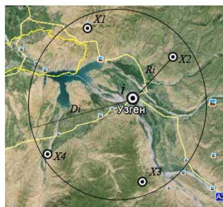
Рисунок 4 – Применение совместной интерполяции спутниковых данных в нескольких узлах для сравнения их с наземными измерениями МС Узген
