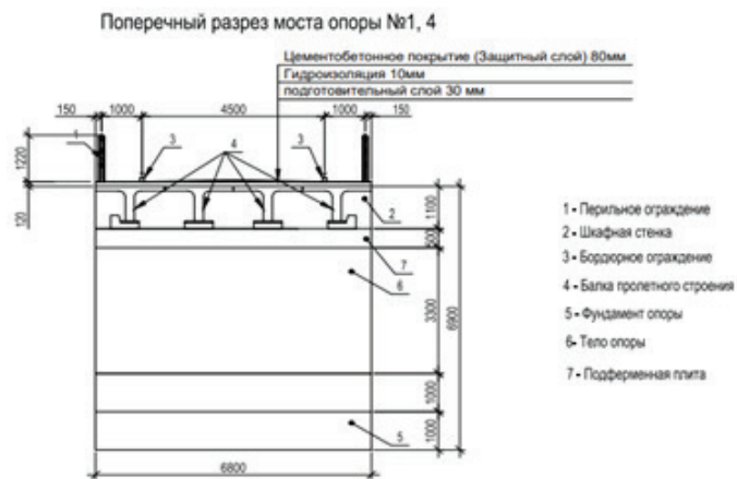
Рисунок 2 – Поперечный разрез моста опоры № 1,4
