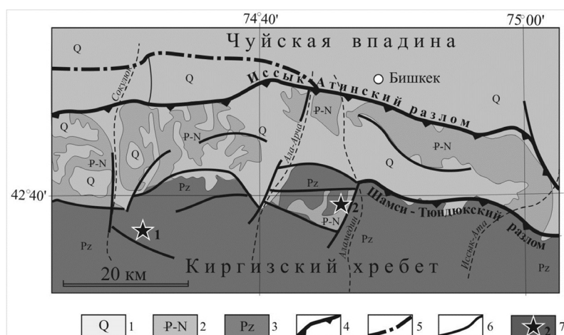
Рисунок 1 – Структурно-геологическая схема зоны сочленения Киргизского хребта и Чуйской впадины (Южно-Чуйская зона): 1 – четвертичные отложения (включая шарпылдакскую серию N 2 -Q 1 ); 2 – палеоген-неогеновые отложения; 3 – палеозойский фундамент; 4–6 – разломно-флексурные зоны: 4 – главные, 5 – по геофизическим данным, 6 – прочие; 7 – участки проявления оползневых процессов: Сукулюкский (1) и Чункурчакский (2)
