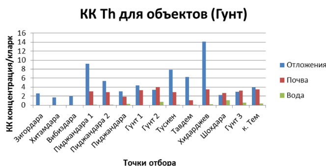
Рисунок 6 – Распределение тория в донных отложениях, почвах и воде
