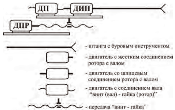
Рисунок 4 – Схема привода ВПМ, позволяющего применять элементы интеллекта в управлении
