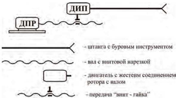
Рисунок 3 – Схема привода ВПМ с отдельным приводом вращения и подачи инструмента
