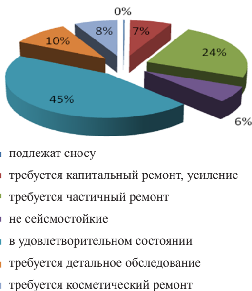
Рисунок 4 – Состояние обследованных зданий в Чуйской области и г. Бишкек
