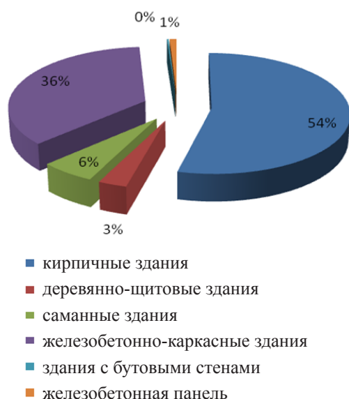
Рисунок 3 – Структура застройки обследованных зданий в Чуйской области и г. Бишкек
