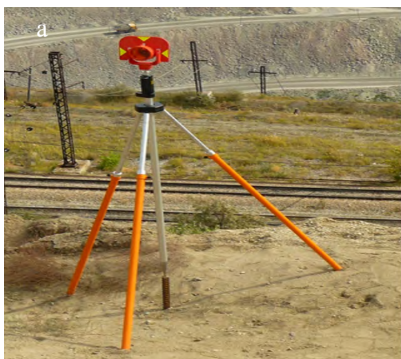
Рисунок 2 – Производство измерений с помощью электронного тахеометра: а – отражатель на репере; б – тахеометр на опорной точке
