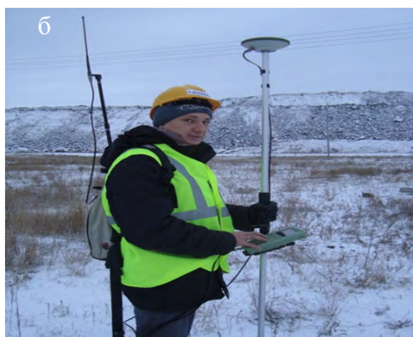
Рисунок 3 – Производство измерений с помощью GPS: а – на опорном пункте; б – на рабочем репере
