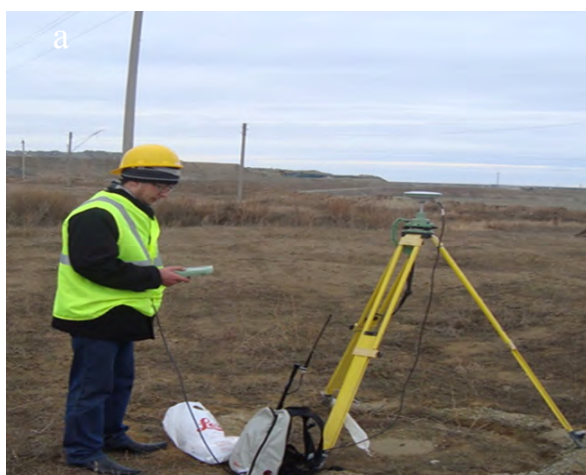
Рисунок 3 – Производство измерений с помощью GPS: а – на опорном пункте; б – на рабочем репере
