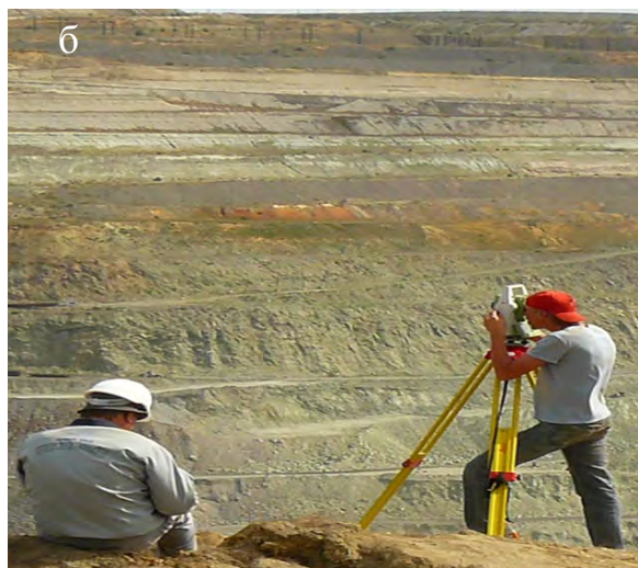
Рисунок 2 – Производство измерений с помощью электронного тахеометра: а – отражатель на репере; б – тахеометр на опорной точке
