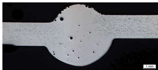
Рисунок 5 – Микрошлиф сварного шва, V = 3,5 м/мин
