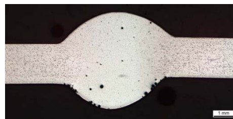
Рисунок 6 – Микрошлиф сварного шва, V = 4 м/мин
