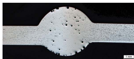
Рисунок 8 – Микрошлиф сварного сварного шва, V = 5 м/мин
