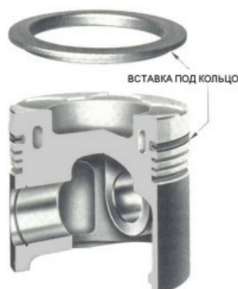
Рисунок 1 – Вставка для поршневого кольца в поршне дизельного двигателя
